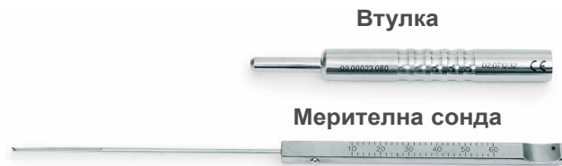
Фигура 2: Разглобено състояние на дълбокомери от тип 1
