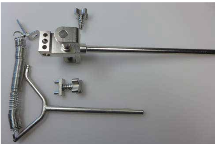
Отделете двата водещи пръта и отстранете двата заключващи винта. Не е необходимо допълнително разглобяване.
