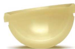
ポリエチレンの内部まで均一にビタミン E が浸透している
