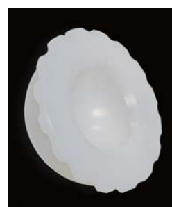
UHMWPE=超高分子量 ポリエチレン製ライナー (第一世代HXLPE)
